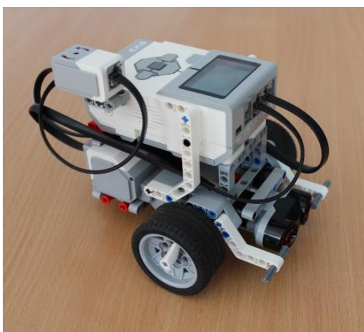
Рис.1. Модель робота с ультразвуковым и гироскопическим датчиками
